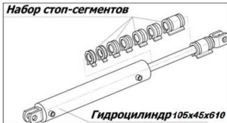
Рисунок 6.2 – Установка стоп-сегментов на шток гидроцилиндра
